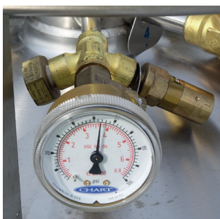
Painemittari ja sen takana paineentausventtiili (oik.) ja murtokalvo (vas.).
