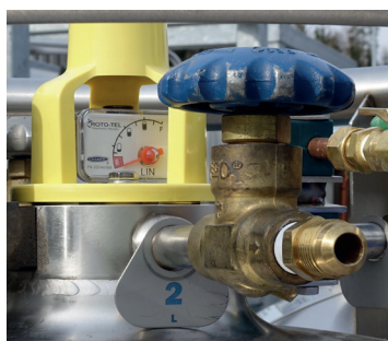
Määrämittari näyttää nesteen määrän säiliössä (kuva havainnollinen). Määrämittarit ovat erilaisia eri valmistajilla. Oikeanpuoleisessa kuvassa näkyy myös sulkuventtiilin kilpi.
